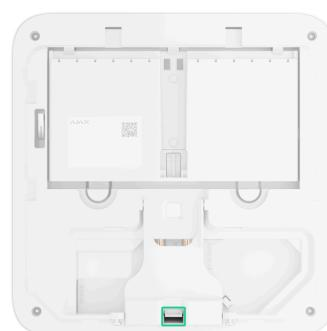
**3.** Connectez les câbles Ethernet et d'alimentation aux connecteurs appropriés.
